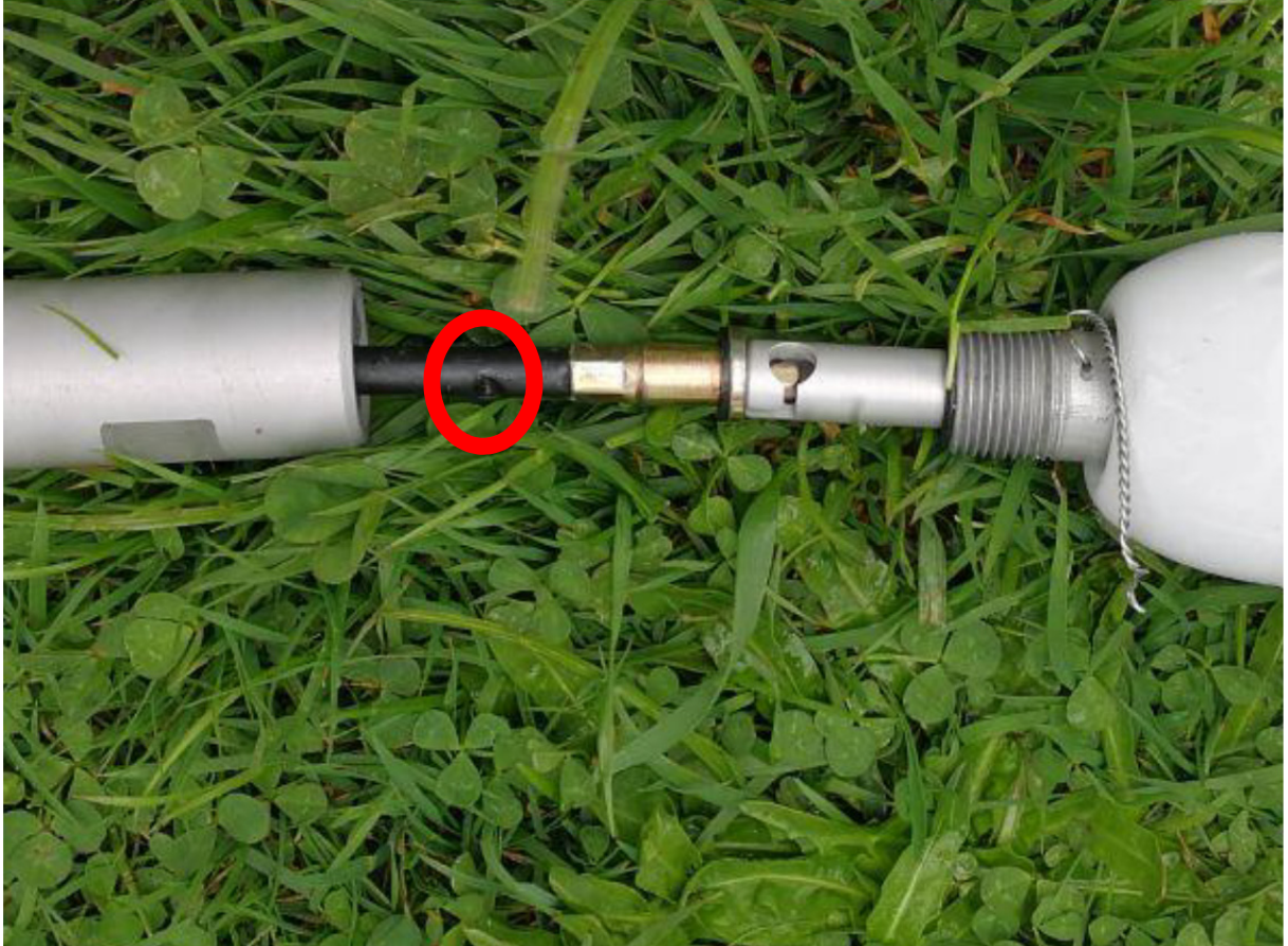
Quetschung am Auslösekabel des Rettungssystems
